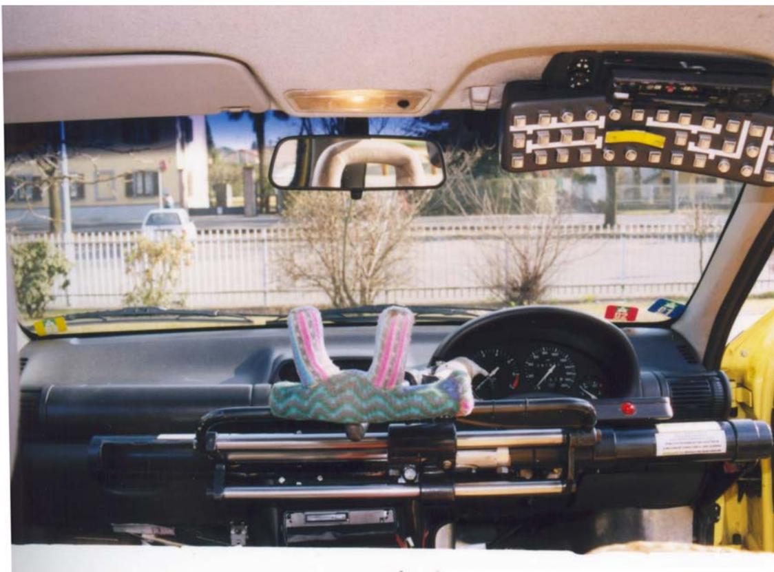
La pulsantiera, eseguita con tasti particolarmente sensibili, viene azionata, con la bocca, mediante una bacchetta. Da qui vengono comandate **tutte** le normali utenze elettriche del veicolo compresa la selezione delle marce, il freno a mano e gli specchietti elettrici.
